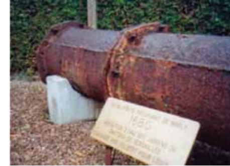
Рис. 3. Труба из серого чугуна в садах Версаля, прослужившая 330 лет
