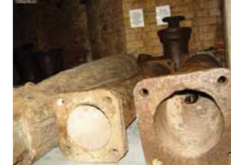
Рис. 4. Трубы из серого чугуна в Петергофе, прослужившие 150 лет
